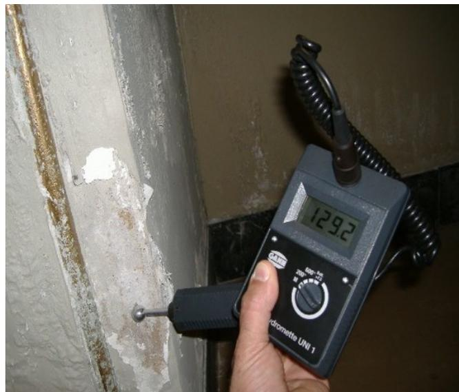
**3. MISURAZIONE** Ponderale tramite prelievi, eseguito secondo normativa UNI 11085:2003 del 01/11/2003. Con foro diametro 10 mm. profondità nel muro di 10/15 cm. e prelievi a varie altezze in diverse posizioni nello stabile. Viene utilizzata una Bilancia ad alta precisione con camera di essiccazione; tarata secondo la normativa suddetta; che permette di quantificare esattamente l'umidità presente all'interno del muro. **L'UMIDITA' del muro è ESPRESSA IN % DI PESO D'ACQUA**
